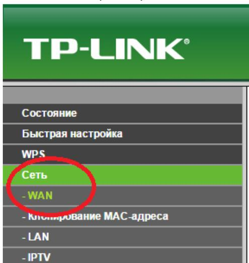
5. В центральной части окна выберите «Тип подключения WAN» -> «Динамический IP-адрес» и нажмите кнопку «Сохранить» в нижней части окна:
